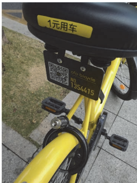
写真2 一切の電子端末を搭載していなかった初期の ofo (2017 年 2 月 20 日伊藤亜聖撮影)
