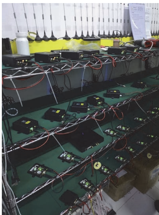
写真6 深圳市沐騰科技のIoT 基板のエイジング工程(2019 年 1 月 18 日伊藤亜聖撮影)
