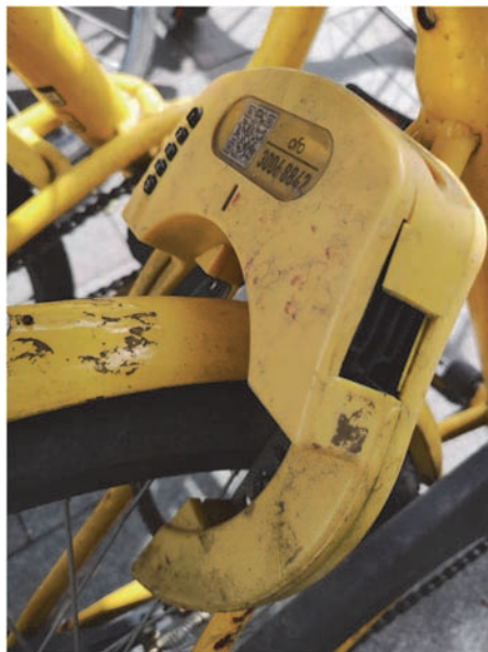
写真3 NB-IoT 端末機器の老朽化が進む ofo 端末(2018 年 11 月 17 日伊藤亜聖撮影)
